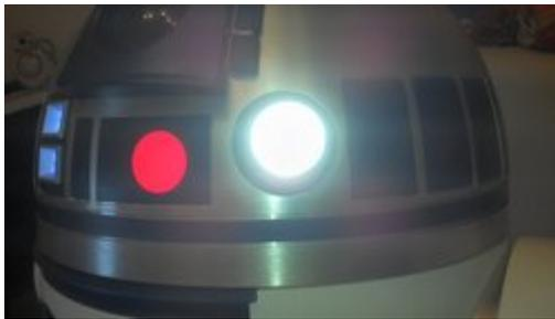
Die LED ist ziemlich hell und der dazugehörige Diffusor eine Halbkugel, die ein gutes Stück aus dem Holo herauschaut. Optimal ist das nicht - also werde ich noch aus den Plexiglasresten eine Scheibe zurechtschneiden, die eingesetzt werden kann.
