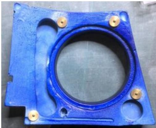
Jetzt das Resin-Teil am Dome ausrichten und fest andrücken. Die Spitzen der Messingteile hinterlassen gut sichtbare Eindrücke im Alu.
