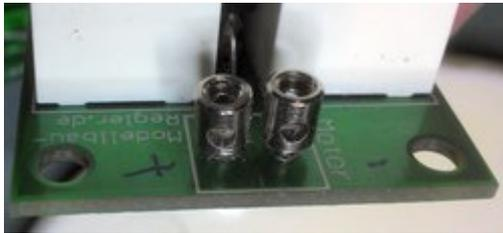
Zu allem Glück kam noch, dass das Kunststoffgehäuse der ursprünglichen Schraubklemme nach ein paar Schnitzereien über die Anschlüsse passte - natürlich anders herum als im Original. So wurden noch zwei Löcher in die Rückwand gebohrt, damit die Kabel eingeführt werden konnten.
