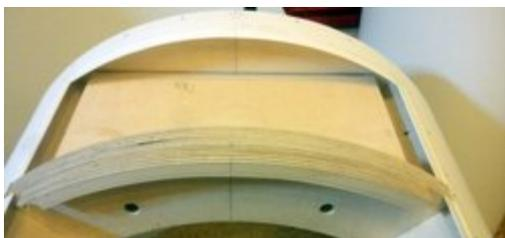
Ich hatte ja für beide Türen von innen einen 1cm breiten Anschlag an alle Seiten geklebt. Um die 1mm Dicke dieses Anschlags auszugleichen und gleichzeitig den Türen mehr Stabilität zu verleihen, habe ich sie beide innen noch einmal mit einer Lage 1mm Polystyrol verkleidet.
