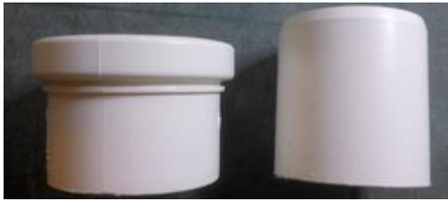
Später kann dann das dünnere Rohr in den dickeren Teil eingesteckt werden. Zuerst muss aber noch Aluklebeband in das Innenrohr, um das Licht auch schön zu reflektieren.
