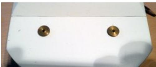
Dann den Zylinder in Position draufgesetzt und die Körnung ins Plastik gedrückt wird. Jetzt noch die Gegenparts der Löcher im Zylinder gebohrt und den 6er Holzdübel eingesetzt.
