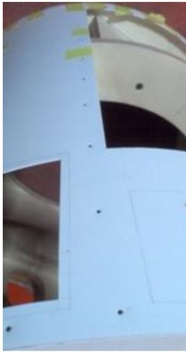
Was auch schon zu erkennen ist: hinten werde ich den Wartungszugang per Tür einbauen - aber mit zwei getrennten Türen. Eine schmale oben, hinter der sich die Hauptschalter und Sicherungen befinden werden und eine größere unten, durch die dann die Innereien zugänglich sind.
