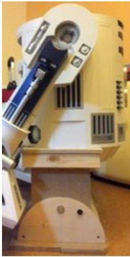
Unter den mittleren Fuß kann man noch zwei Leisten legen und so schon mal losschrauben. Die Leisten helfen logischer Weise vor allem beim Aufbau und halten den Fuß schon mal da, wo er hinkommt, damit von oben in Ruhe die Schrauben reingedreht werden können.
