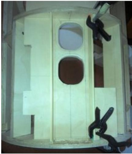
Auf dem Bild ist auch zu erkennen, dass ich nochmal ein großes senkrechtes Brett eingeklebt habe, auf dem die Umriss der front vents zu erkennen sind. Die stoßen hier genau an das Brett, so dass ich später zum besseren Halt hier noch ein 3mm-Ausschnitt der vents dagegenlebe, der sie von hinten hält. Außerdem musste das Brett noch mit zahlreichen Ausschnitten am Rand versehen werden, damit die coinslots und -return Platz haben.
