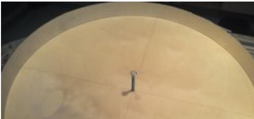
Der Durchmesser beträgt genau 458mm. Ich schneide noch Felder raus und lasse drei Speichen stehen, damit ich an das Innere des Kopfes kommen kann. Die Platte selbst wird im Kopf verleimt und zusätzlich von außen mit Schrauben an der inneren Kuppel befestigt.
