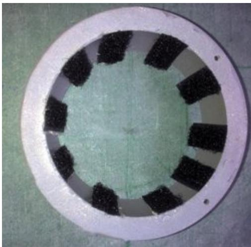
Einem frisch eingetroffenem Holo wurde ausgiebig mit Schleifpapier und Stahlwolle zu Leibe gerückt. Die Zwischenräume im oberen Teil habe ich mit einem flachen Schraubendreher in eben dieser Breite bearbeitet.
