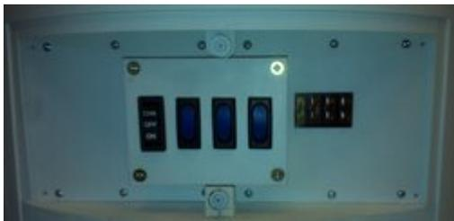
Zur Abdeckung des Kabel-Wirrwars innen und vor allem der bloßliegenden Sicherungsanschlüsse habe ich noch eine 3mm-PS-Platte geschnitten.
