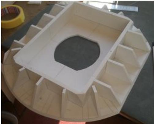
Die untere und obere Platte habe ich mit Schnellbau-Schrauben und Kleber an den Kasten geschraubt. Diese Schrauben bohren sich ja ihr eigenes Loch, so dass hier nix vorzubohren war. Als Kleber habe ich schnöden Uhu-Allleskleber verwendet, da der normale Plastik-Modellbau-Kleber für das Polystyrol hier nicht gut hält.
