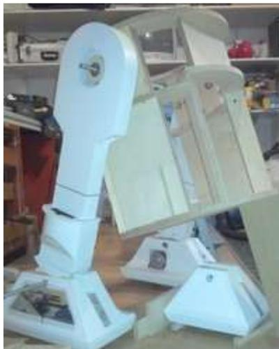
Das mittlere Bein habe ich ebenfalls abnehmbar gestaltet. So habe ich zunächst eine Platte geschnitten, die ebenfalls mit vier 8er Schrauben mittels Einschlagmuttern mit der Bodenplatte verschraubt werden kann. Ich weiß - total überdimensioniert - aber das Material lag halt rum .... 🤪
