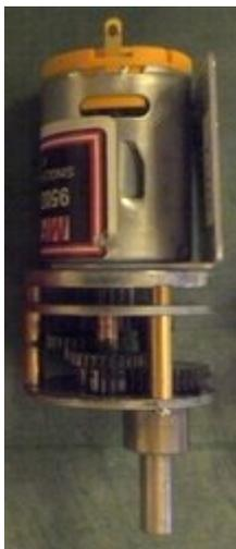
Der Original-Träger wurde durch einen massiven Stahl-Träger ersetzt. Aus den verschiedenen Versuchsteilen für die Motorbefestigung im Fuß hatte ich noch eine weiß lackierte Lochplatte übrig, die tatsächlich ein 11er Loch hat, in die das Vorderteil des Dome-Motors passt. Die Platte musste also nur noch im 90°-Winkel gebogen werden und die beiden Löcher für die Trägerplatte des Getriebes.
