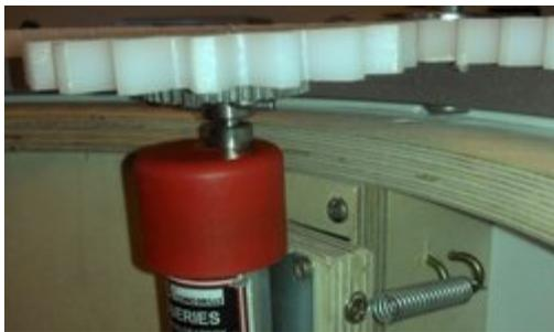
Ein Testlauf des Motors brachte dann das nächste Übel an den Tag: die Zähne von Ritzel und Kranz passen nicht so super genau ineinander, dass sie unter dem Druck der Feder schön sauber ineinander greifen. Das hat zur Folge, dass es zum einen sehr laut ist und zum anderen jeder einzelne Zahn eine höllische Vibration verursacht - so konnte das nicht bleiben.
