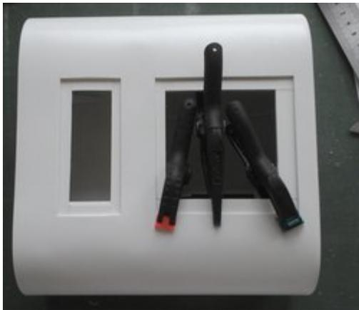
Die Luken wurden von innen mit passenden und überstehenden Streifen aus 3mm-Material versehen, an die die Deckel angeschraubt werden können. Die Deckel hab ich ringsum 2mm kleiner gemacht, um die Fuge zu erhalten. Mit einem 1m-Bohrer wurden in den Deckeln und den Leisten Löcher für die Schrauben vorgebohrt.
