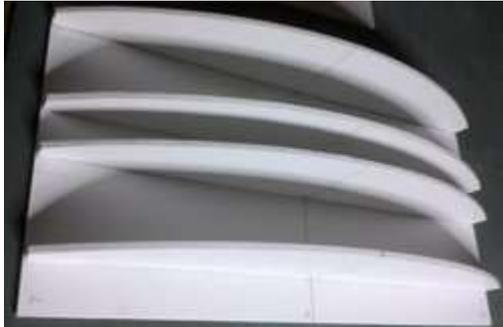
Zunächst habe ich ein 3mm-Polystyrol-Brett als Unterlage zurechtgeschnitten und darauf vier Rippen mit der nötigen Rundung aufgeklebt.
