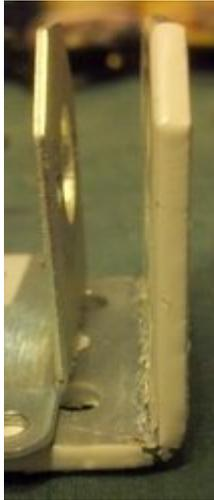
Wie man sieht, ist der neue Träger einiges dicker als der alte und so musste ich etwas längere Schrauben für die Trägerplatte verwenden.
