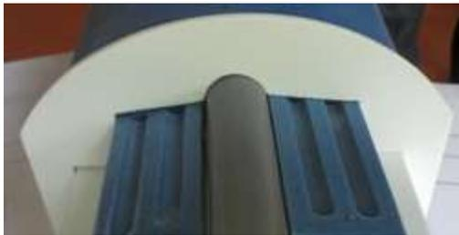
Dann kam das Hufeisen an die Reihe. Es besteht zunächst einmal aus drei großen 3d-Druck-Teilen, die zwar ultraleicht sind, aber so hart, dass sie mit kaum etwas brauchbar zu bearbeiten sind. Die Kanten und Grate gehen ebenfalls mit der "Kanten-kratz-Technik" ganz gut, aber die Oberflächen .... 😬
