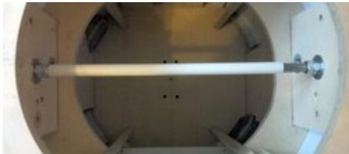
In das Bein schaut nur so viel, dass ich eine Mutter verschrauben kann und trotzdem der Hub drüberpasst. Für die Montage des Beins ist diese Fixierung auch super, das sich die eigentlichen Schrauben für die Bein-Fixierung viel besser eindrehen lassen.
